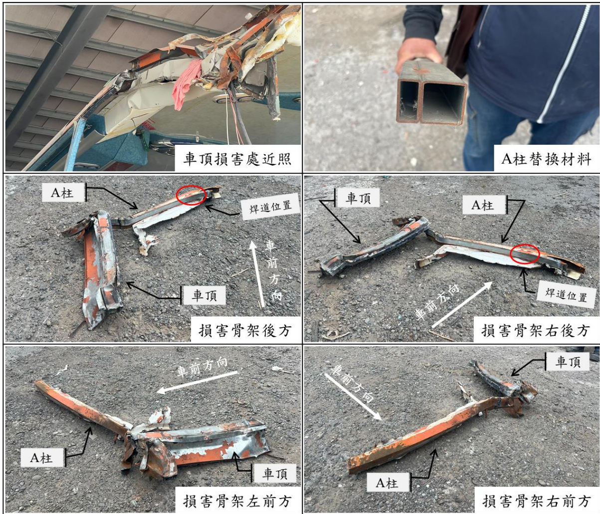
圖 1.3-3 事故車輛骨架損害狀況
