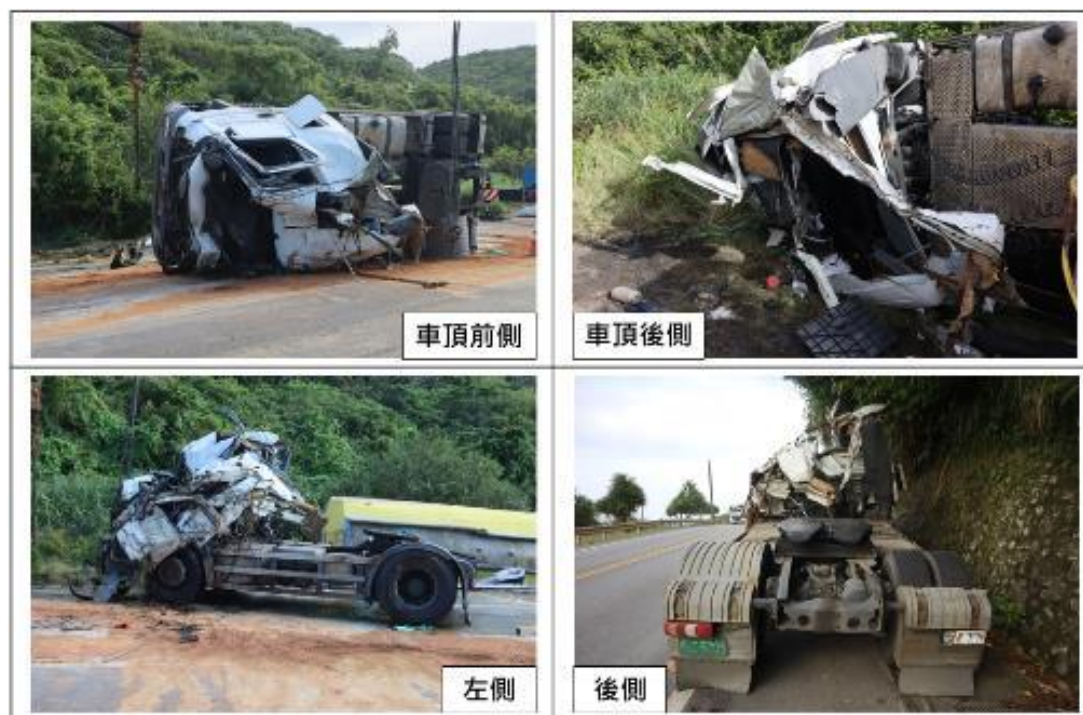
圖 1.3-5 事故曳引車受損情形
