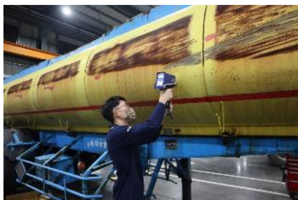
圖 1.3-3 罐槽體厚度及材質量測情形
