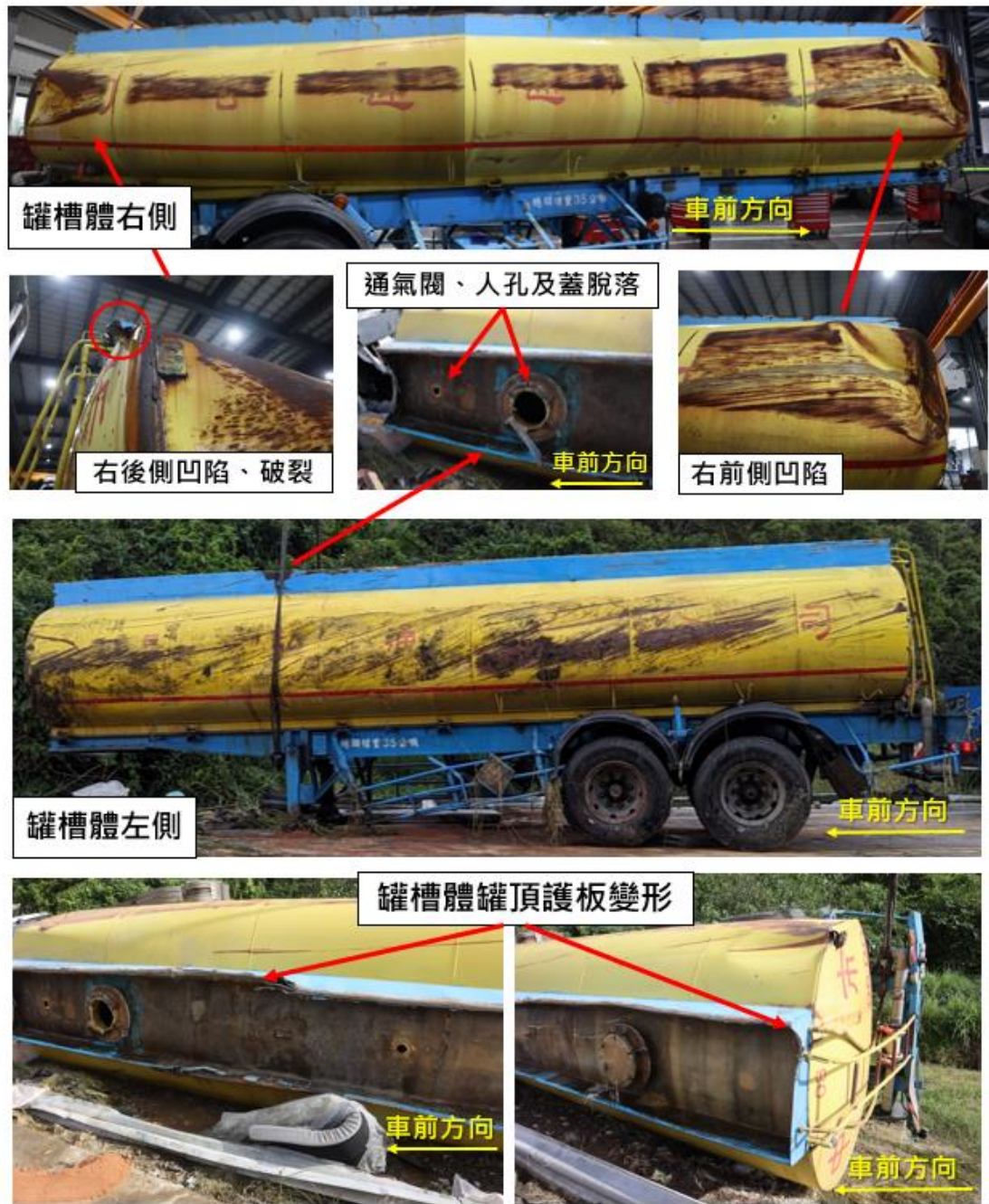
圖 1.3-6 事故半拖車及罐槽體受損情形
