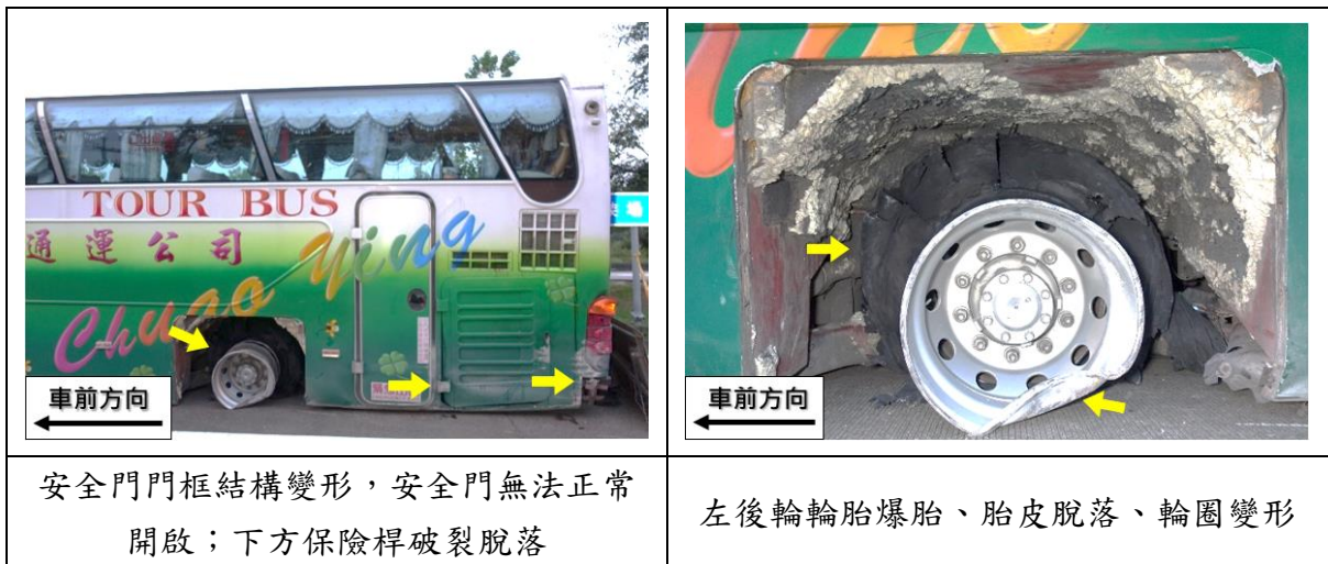
圖 1.3-3 車體損害情形 (3)
