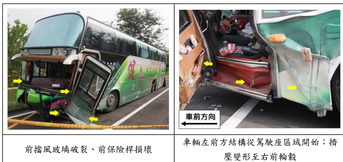
圖 1.3-1 車體損害情形 (1)
