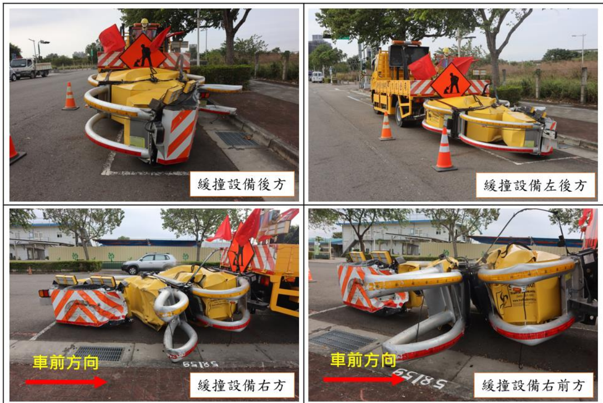
圖 1.4-3 緩撞設施損害情形
