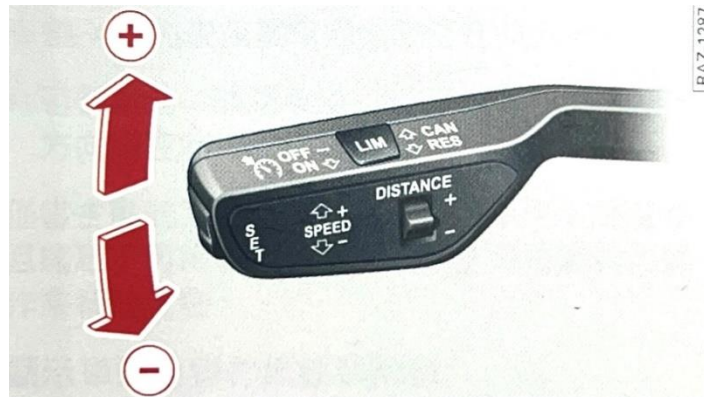
圖 1.16-2 巡航系統控制桿示意圖
