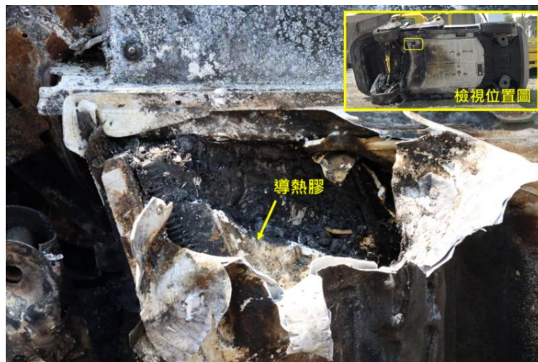
圖 2.3-1 高壓電池組裂縫拆開檢視情形
