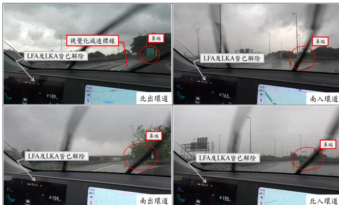
圖 1.13-2 以相同時速行駛各環道之系統解除時機比對圖
