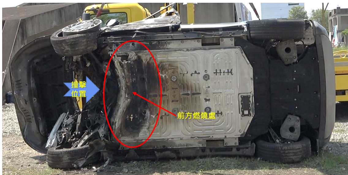
圖 2.3-3 事故車輛撞擊處和電池燃燒處
