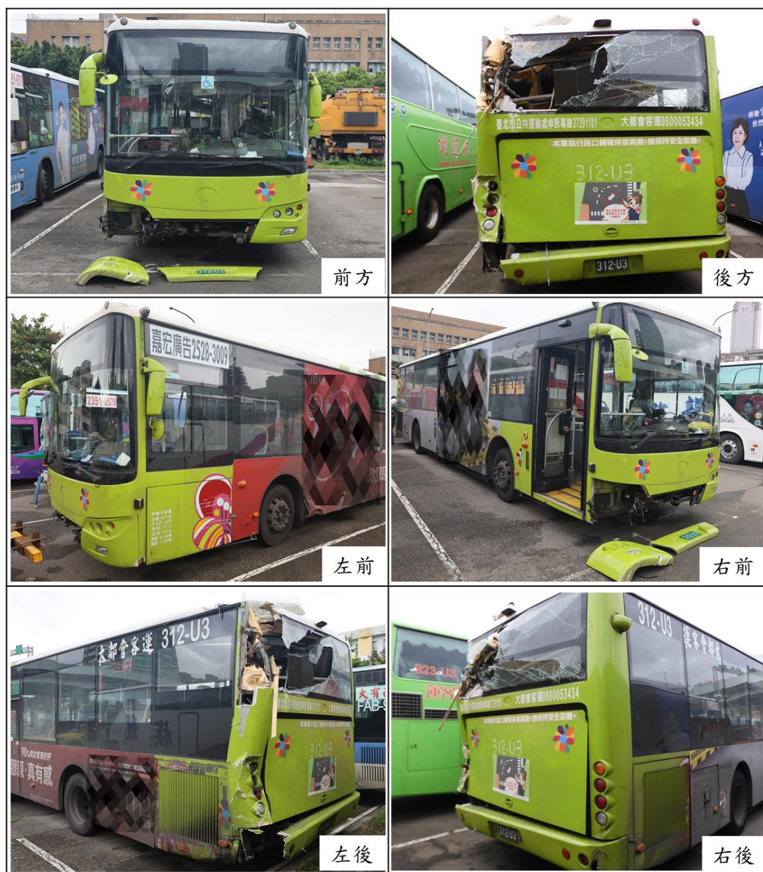
圖 1.4-1 前方公車受損情形
