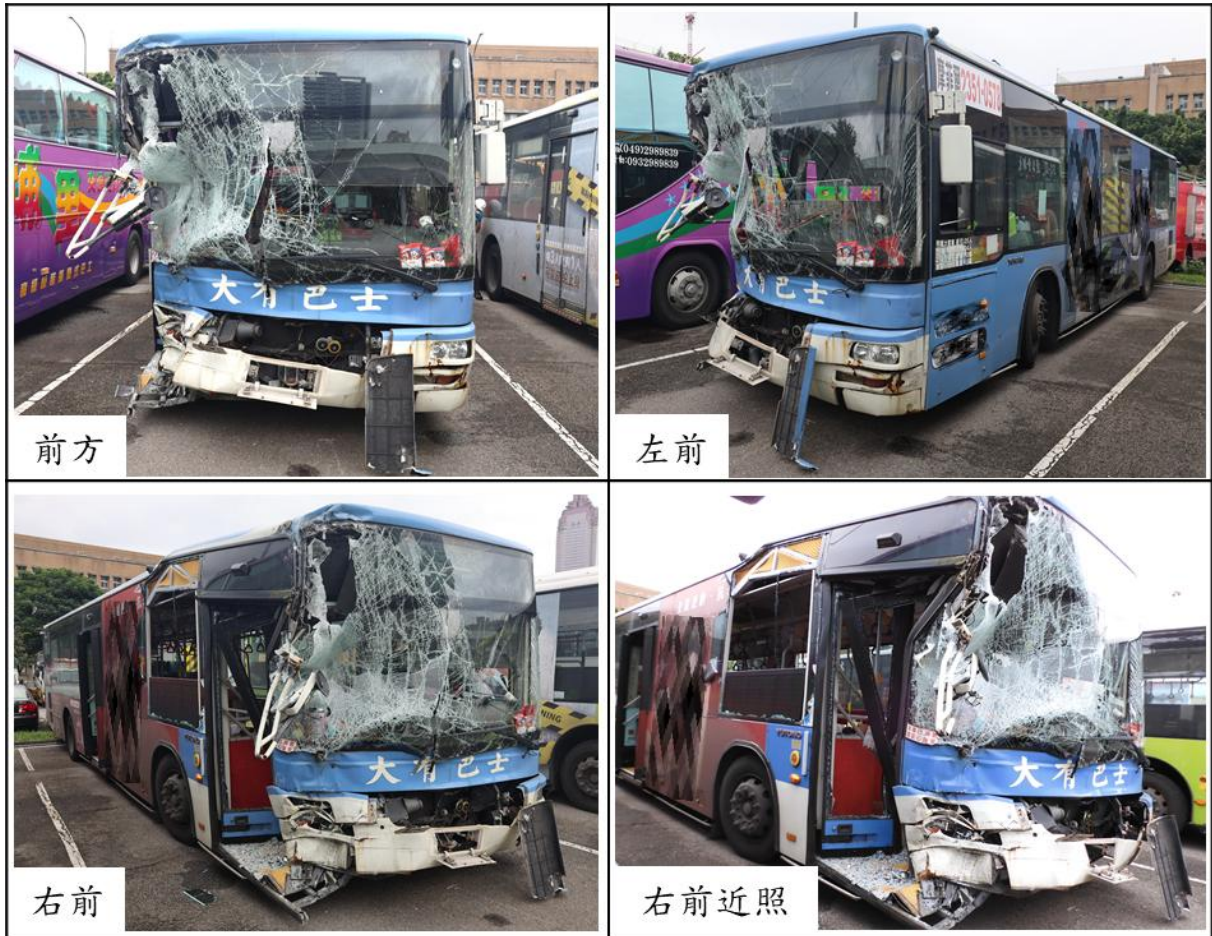
圖 1.3-1 事故車輛外部損害情形
