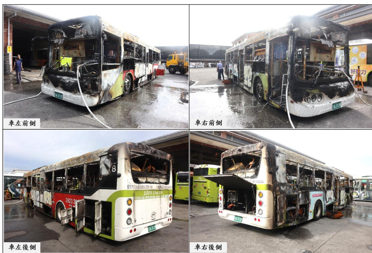
圖 1.3-7 事故車輛外側損害情形
