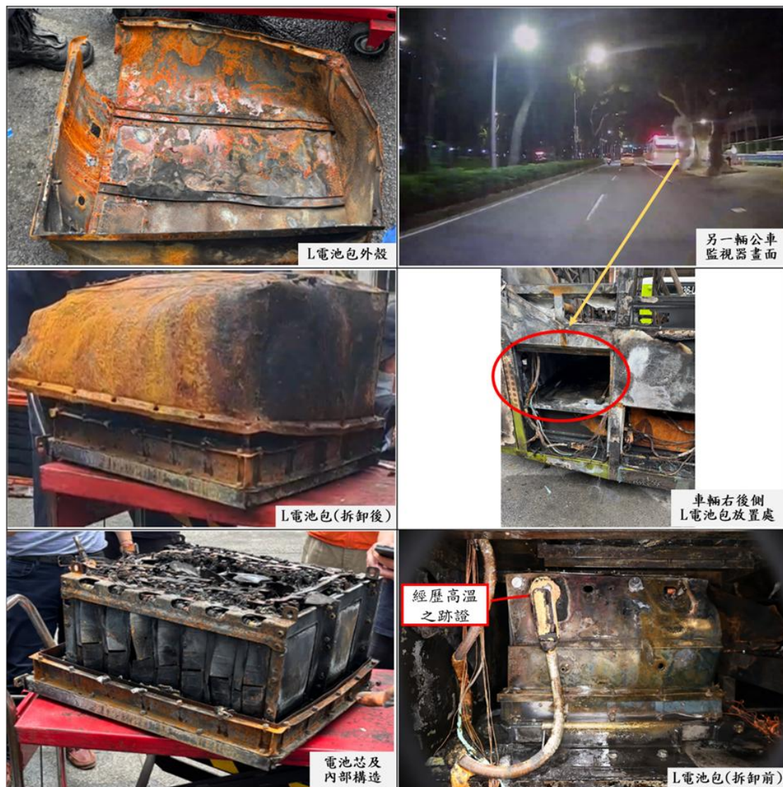
圖 1.3-9 事故車輛 L 電池包損害情形 17
