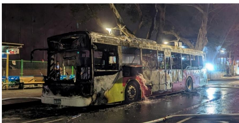
圖 1.1-3 事故車輛火勢撲滅後狀況
