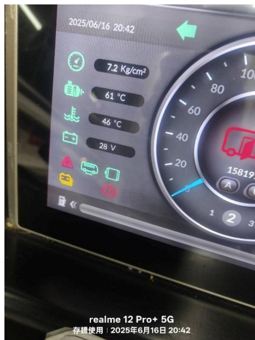
圖 1.9-11 HMI 「大電系統異常」紅燈及「電池警告」黃燈
