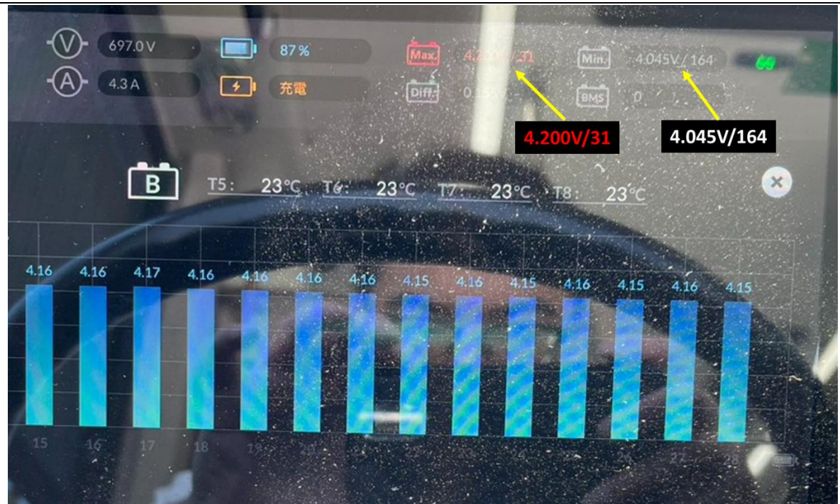
B 電池包電壓及溫度訊息
