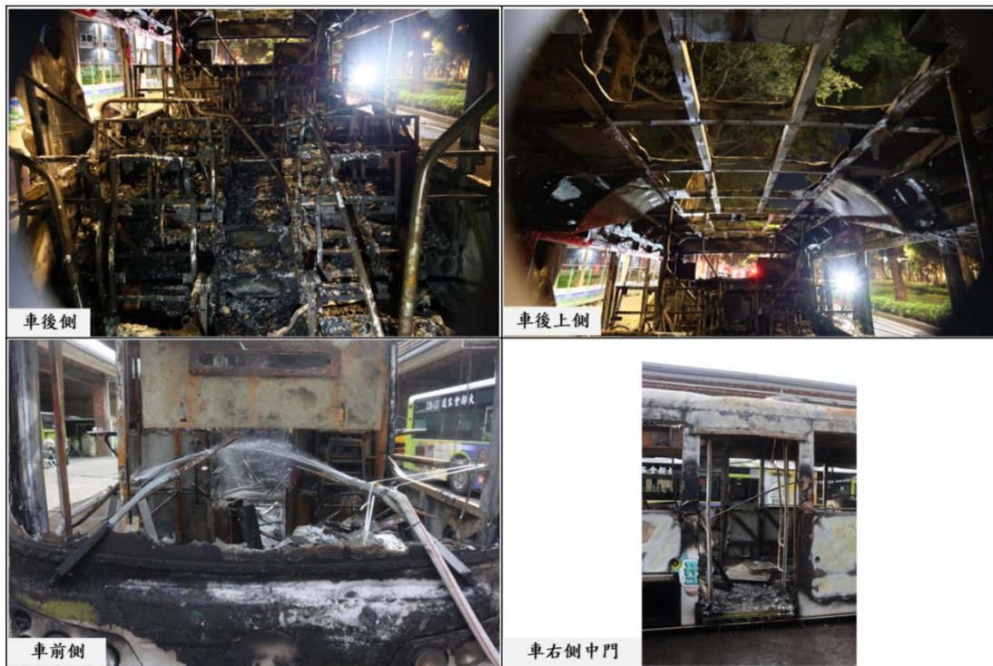
圖 1.3-8 事故車輛內側損害情形
