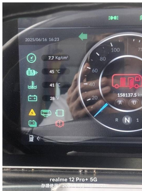
圖 1.9-9 HMI 「大電系統警告」黃燈
