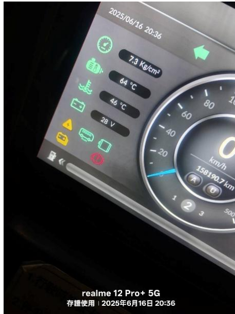
圖 1.9-10 HMI 「大電系統異常」黃燈及「電池警告」黃燈
