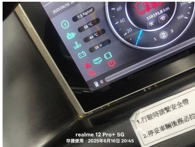
圖 1.9-12 HMI「大電系統異常」紅燈及「電池異常」紅燈
