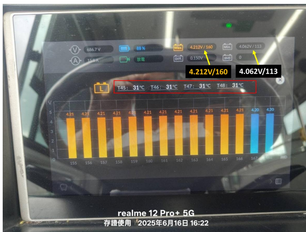
圖 1.9-7 L 電池包 HMI 訊息畫面
