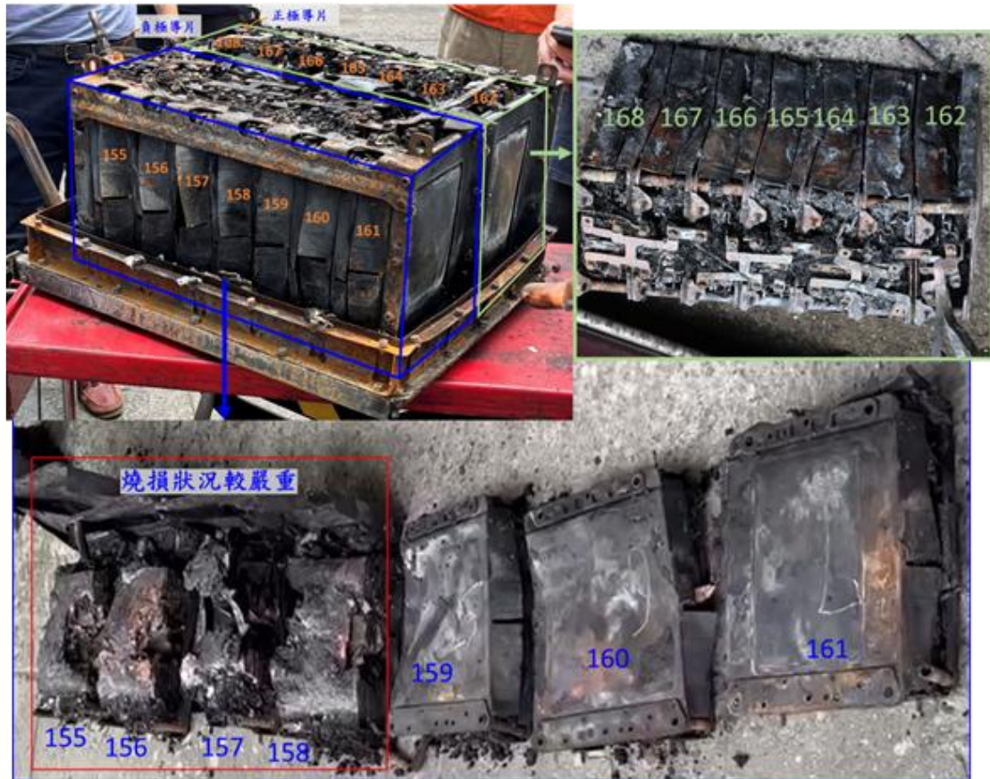
圖 1.3-10 L 電池包內各電芯模組狀態 18
