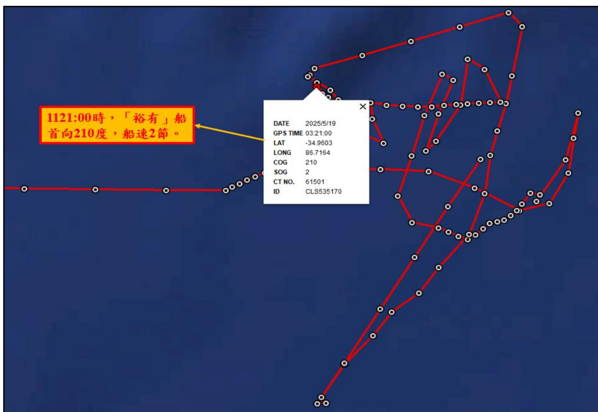
圖 1.1-3 「裕有」搜尋航跡圖及事故時的船舶動態（VMS 航跡紀錄）
