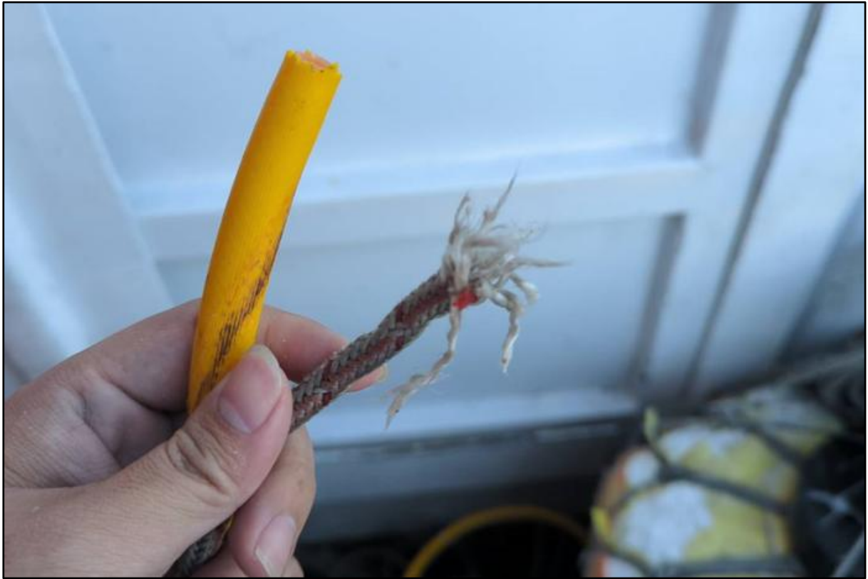
圖 1.6-2 「裕有」收回的安全繩及空氣管斷面（漁業署提供）
