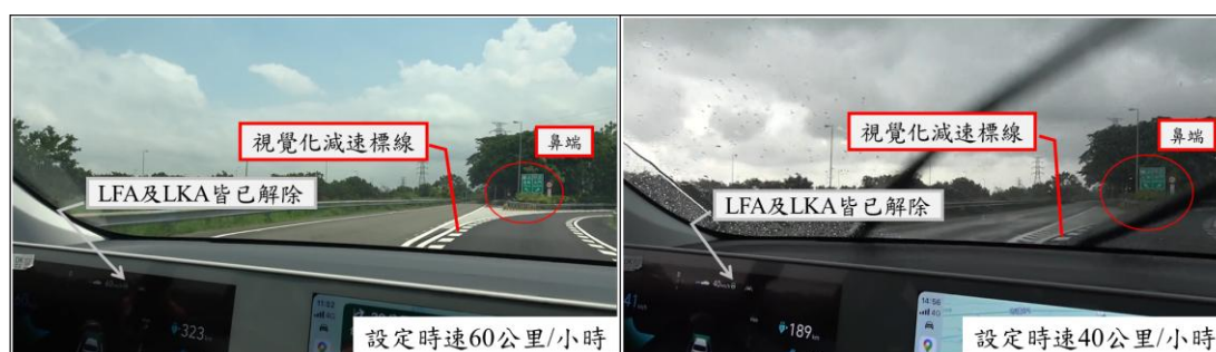
圖 1.13-3 以不同時速行駛北出環道之系統解除時機比對圖
