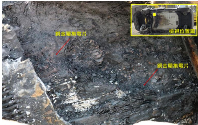
圖 2.3-2 高壓電池組前端內部檢視情形
