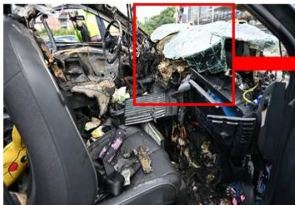
右前座輔助氣囊作動情形
