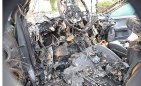
左前座損害情形
