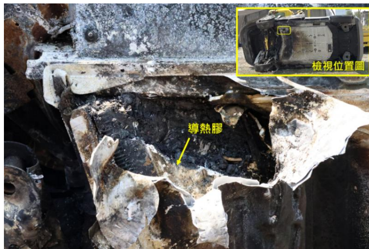
圖 2.3-1 高壓電池組裂縫拆開檢視情形
