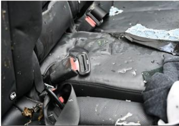
後座安全帶插扣插入插板情形
