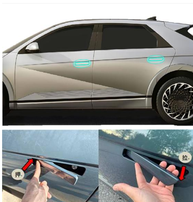
圖 2.5-3 IONIQ 5 緊急救援手冊之手動開啟車門資訊
