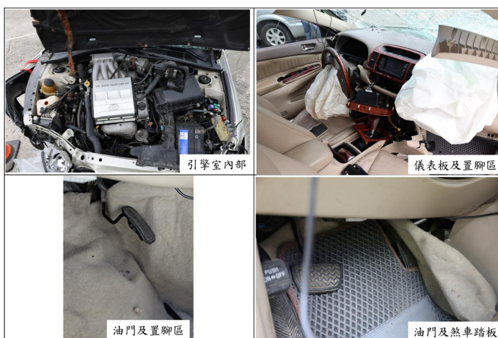
圖 1.3-2 事故車輛內部損害狀況
