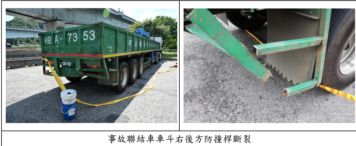
圖 1.3-4 事故聯結車損害情況
