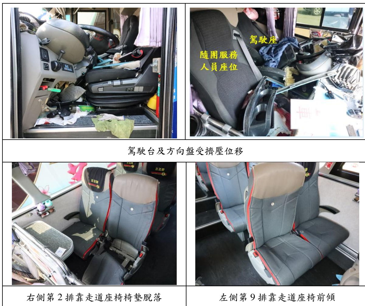
圖 1.3-4 事故車輛座椅損害情況
