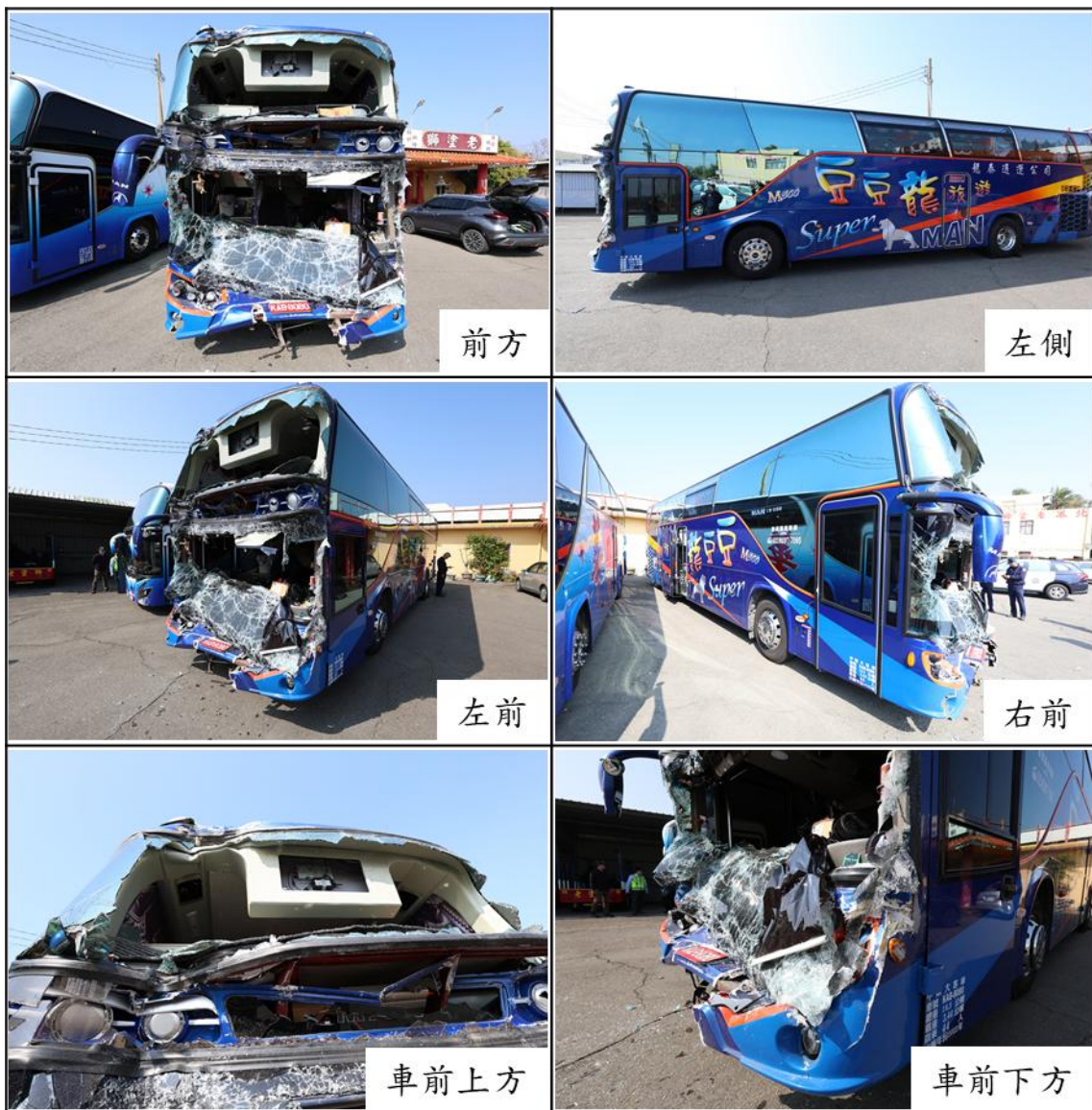
圖 1.3-3 事故車輛外部損害情況
