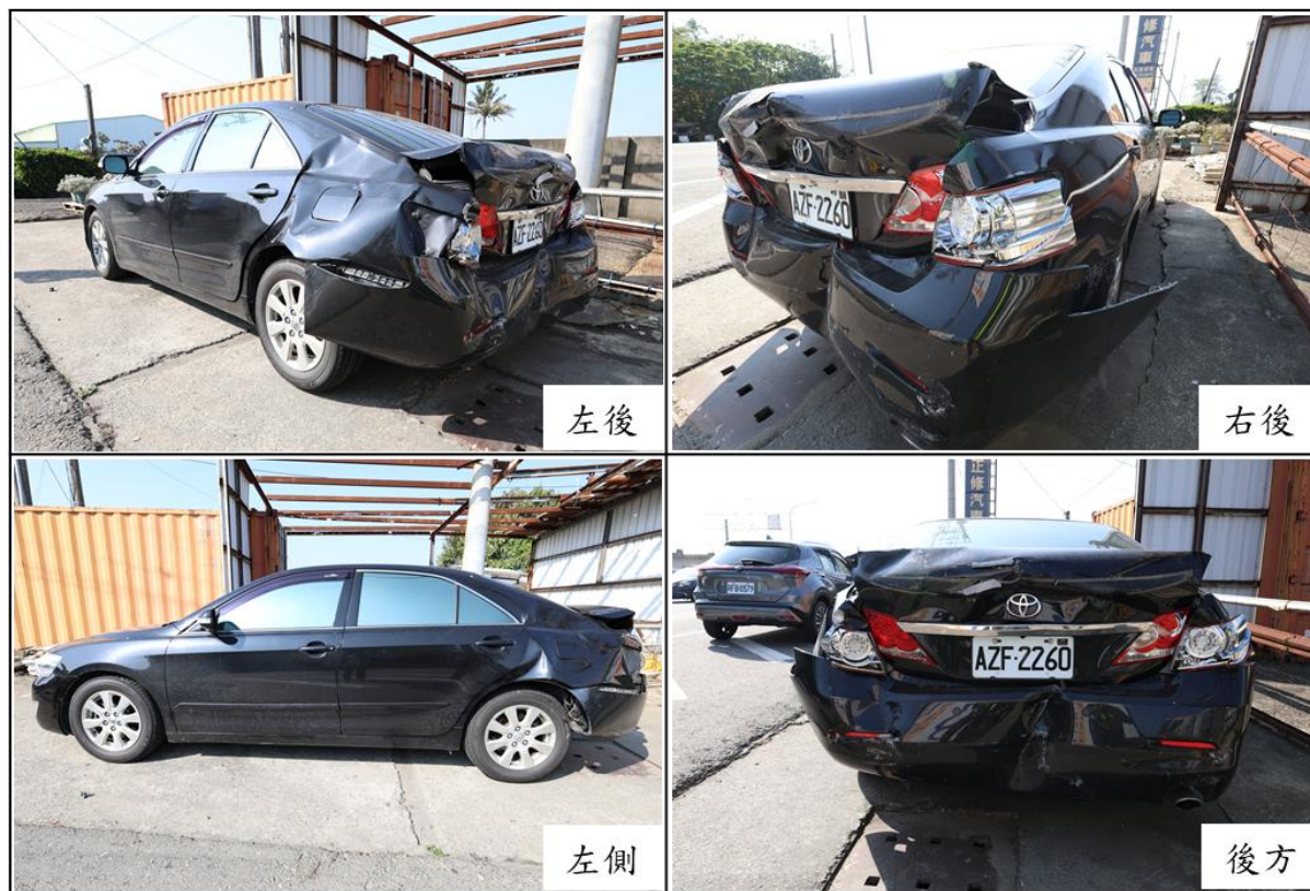
圖 1.4-2 前方小客車損害情況
