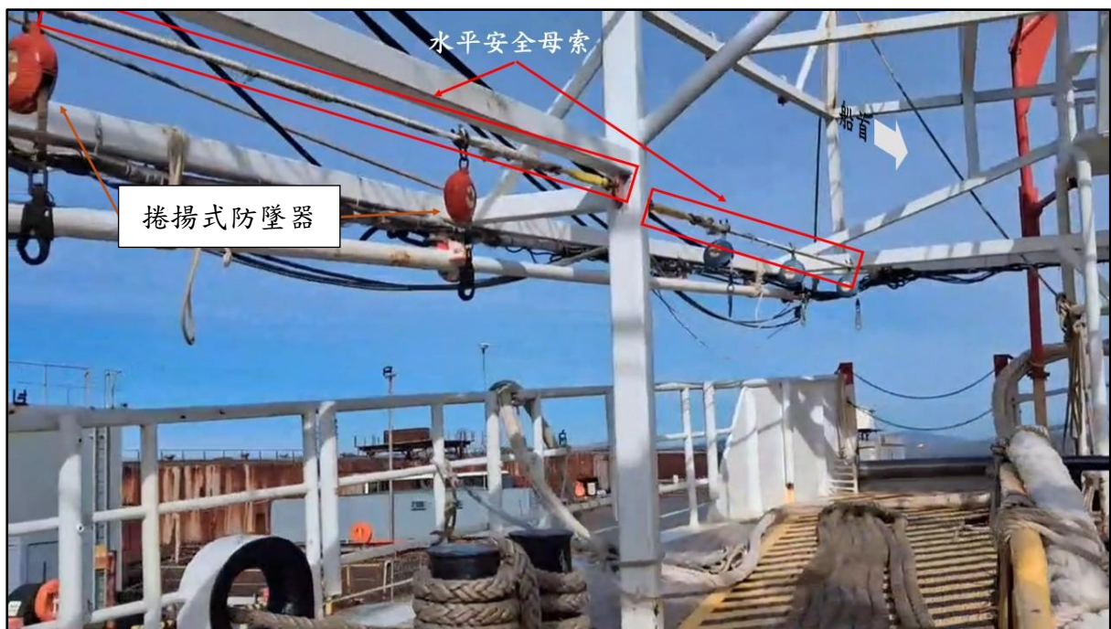
圖 1.7-3 安豐左船首水平安全母索及捲揚式防墜器配置圖
