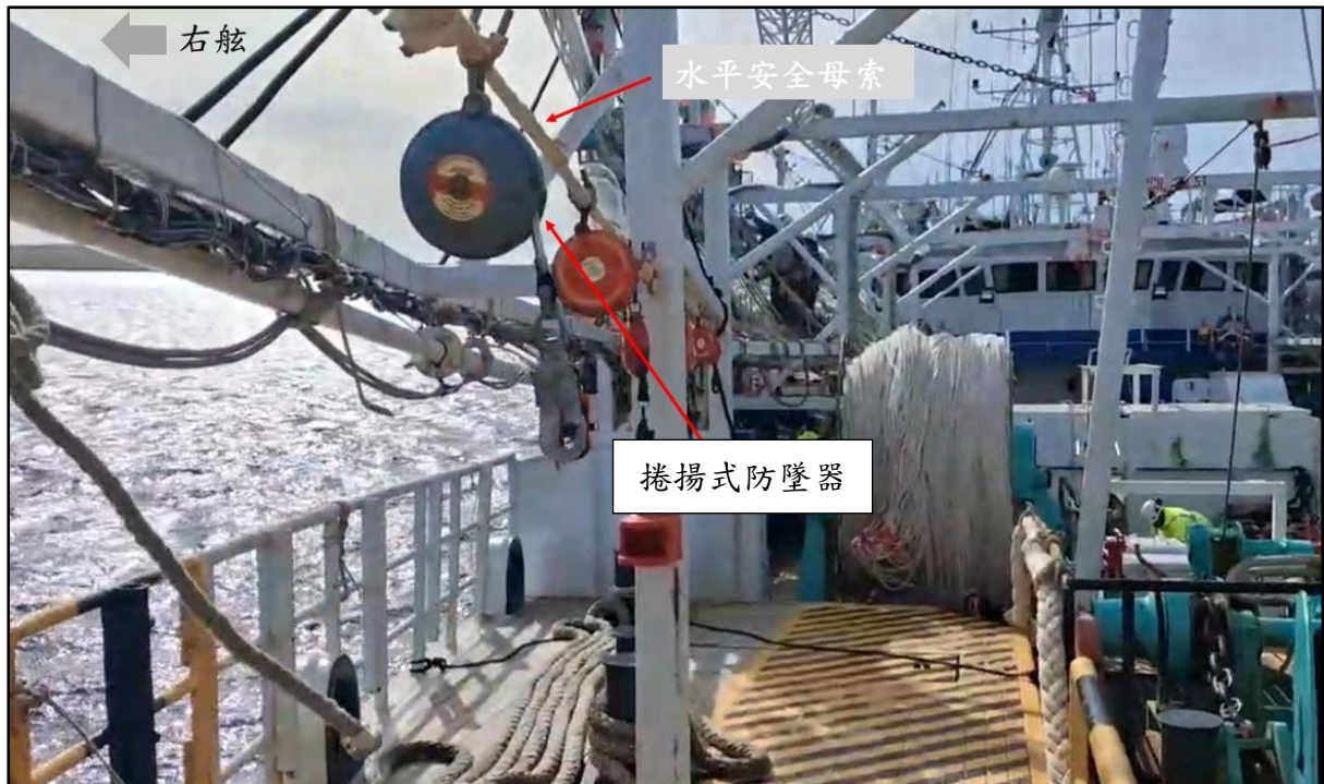
圖 1.7-2 安豐右船首水平安全母索及捲揚式防墜器配置圖
