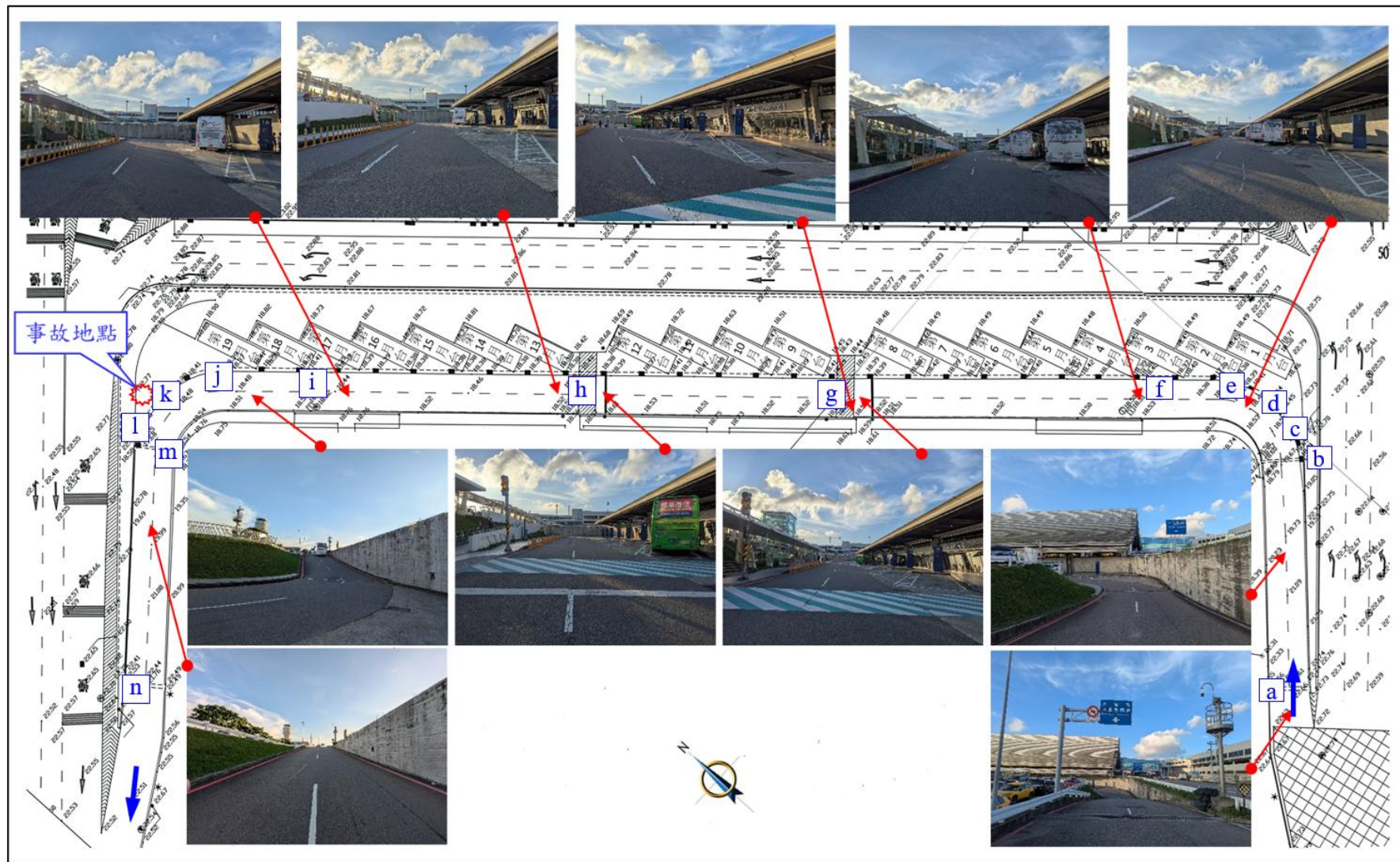
圖 1.8-1 事故路段橫斷面車道配置圖
