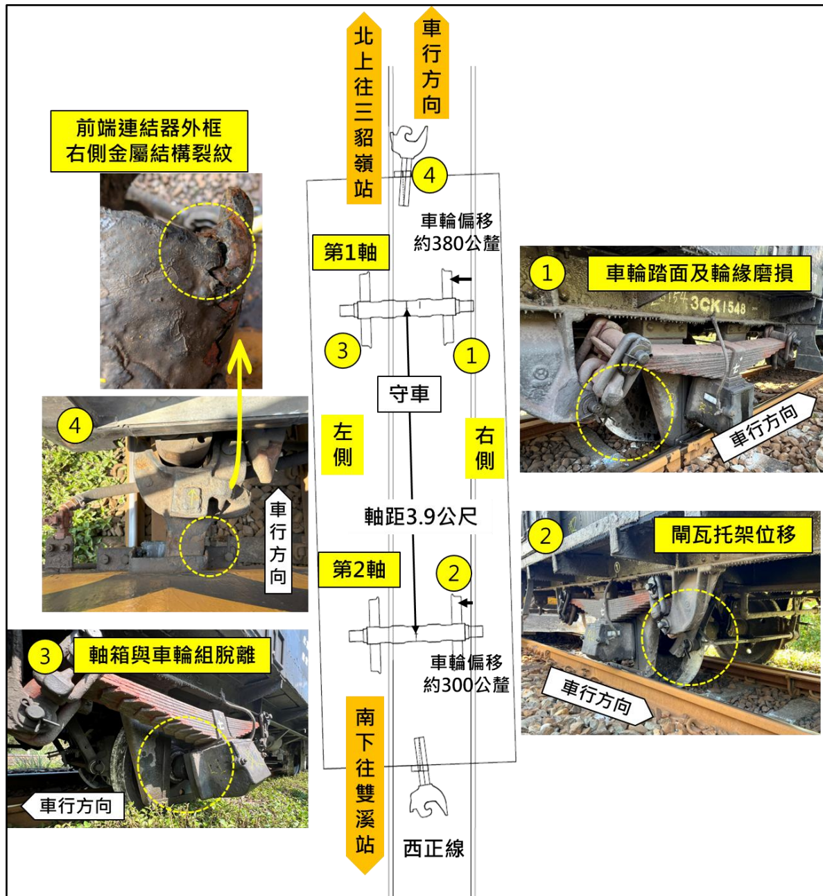
圖 1.2-1 守車損害狀態
