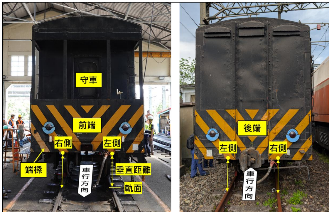
圖 1.10-8 車架端樑高度量測位置
