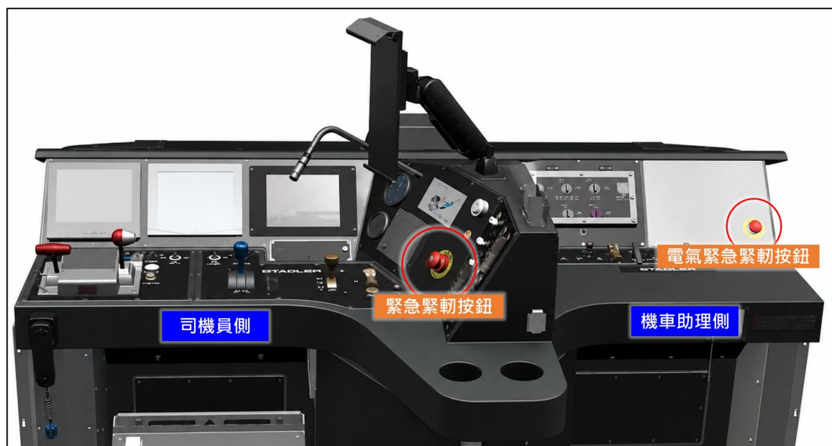
圖 1.5-4 R200 型柴電機車駕駛台配置及緊急停車按鈕
