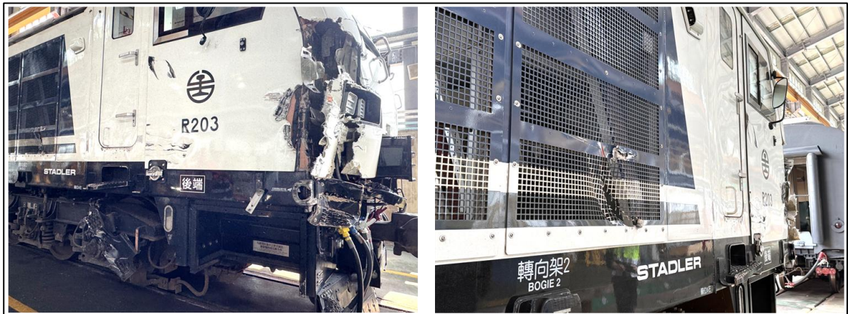
圖 1.3-1 R203 號柴電機車車體損害情形
