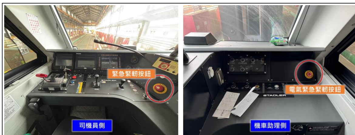
圖 1.12-2 R200 型柴電機車駕駛室緊急停車按鈕
