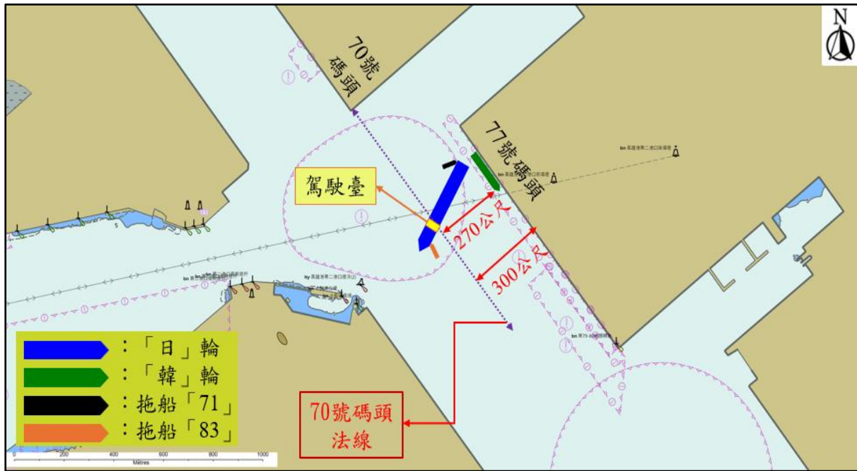
圖 1.7.1-4 「日」輪右舵時拖船配置及相對位置圖
