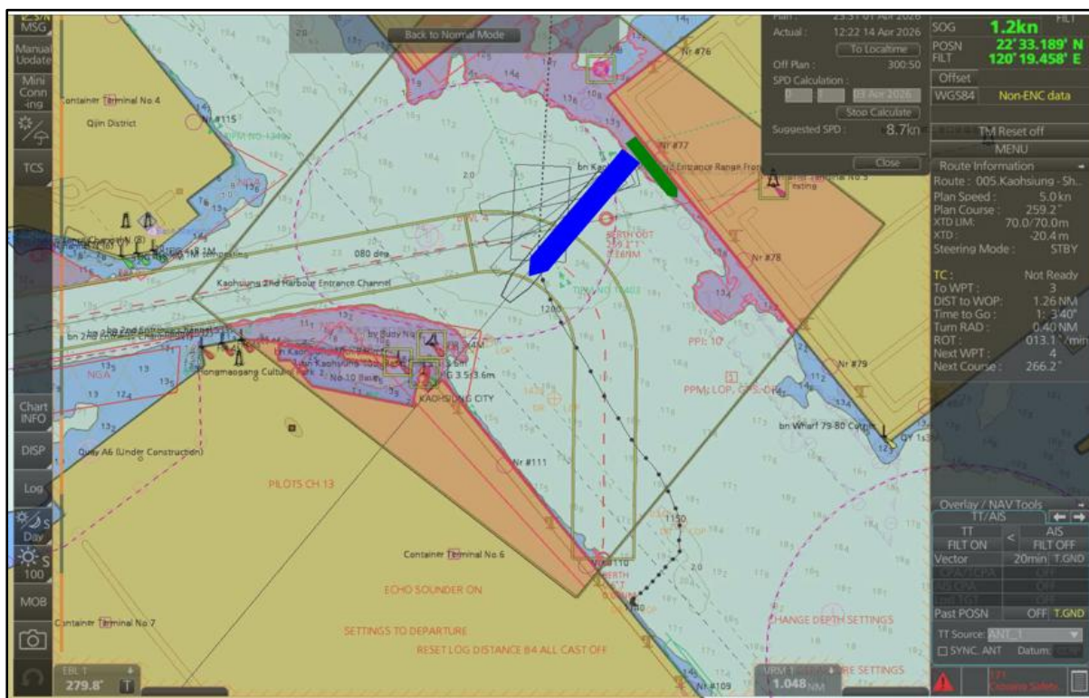
圖 1.7.3-4 「日」輪 ECDIS 截圖與 VDR 船位於碰撞時間點附近時之套疊
