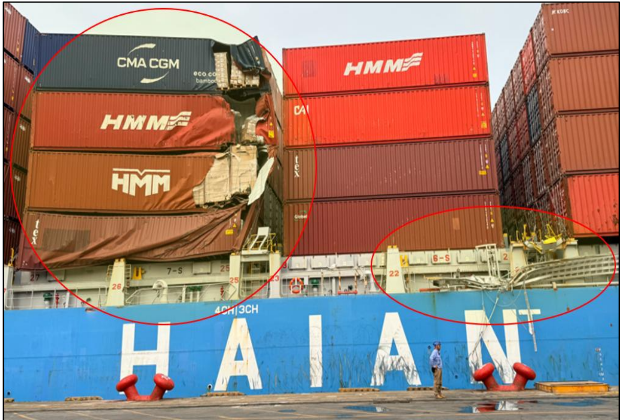
圖 1.3-3 「韓」輪貨櫃及部分甲板設施之受損照片
