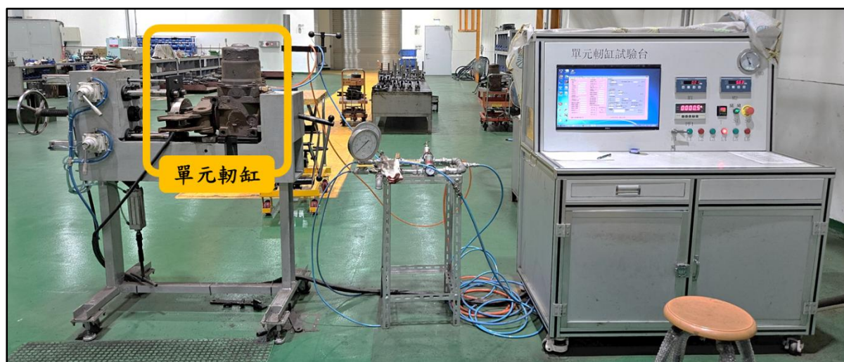
圖 1.9-1 單元軔缸試驗臺
