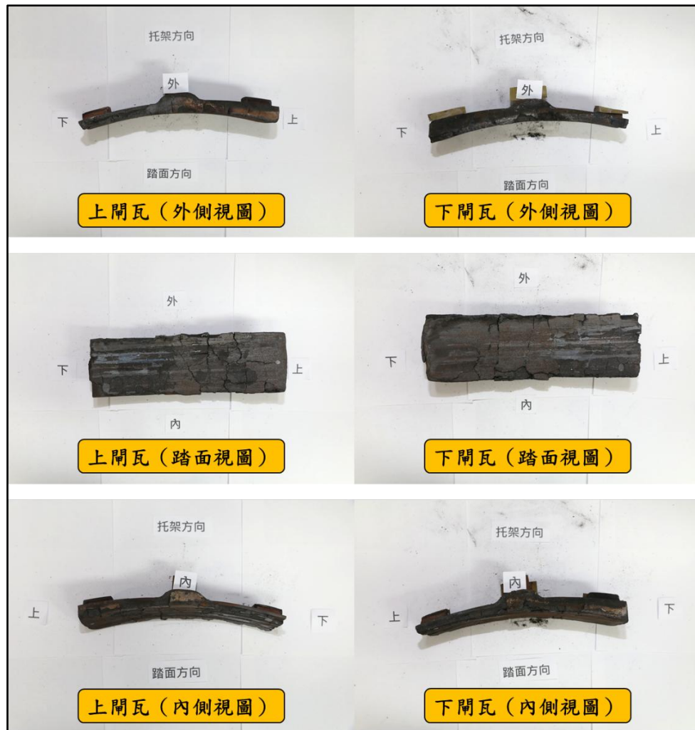
圖 1.3-2 事故車廂 2 軸左側開瓦損傷情況
