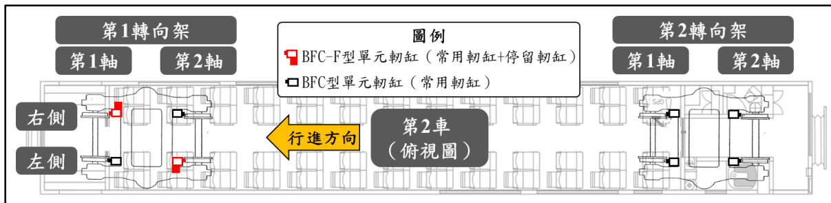
圖 1.5-2 事故車廂單元軔缸配置示意圖
