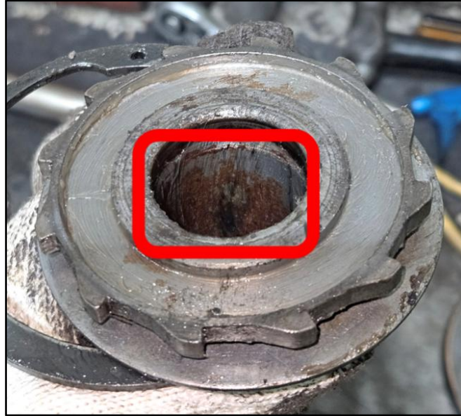
圖 1.9-2 事故車廂 2 軸左側單元軋缸棘輪組內生鏽情形
