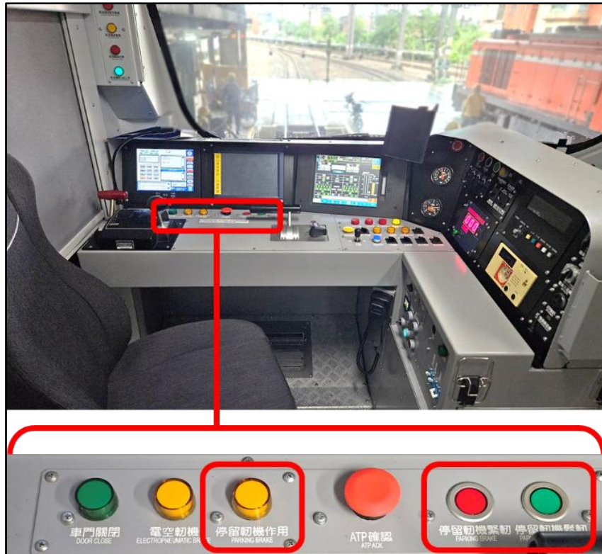
圖 1.5-3 E500 型電力機車駕駛臺停留軔機操作介面圖
