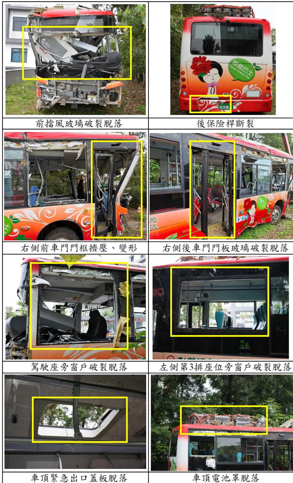
圖 1.3-1 事故車輛外部損害情形
