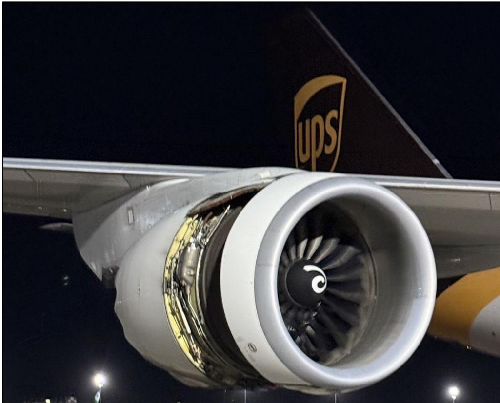
圖 1.1-1 4 號發動機受損之外觀情況
