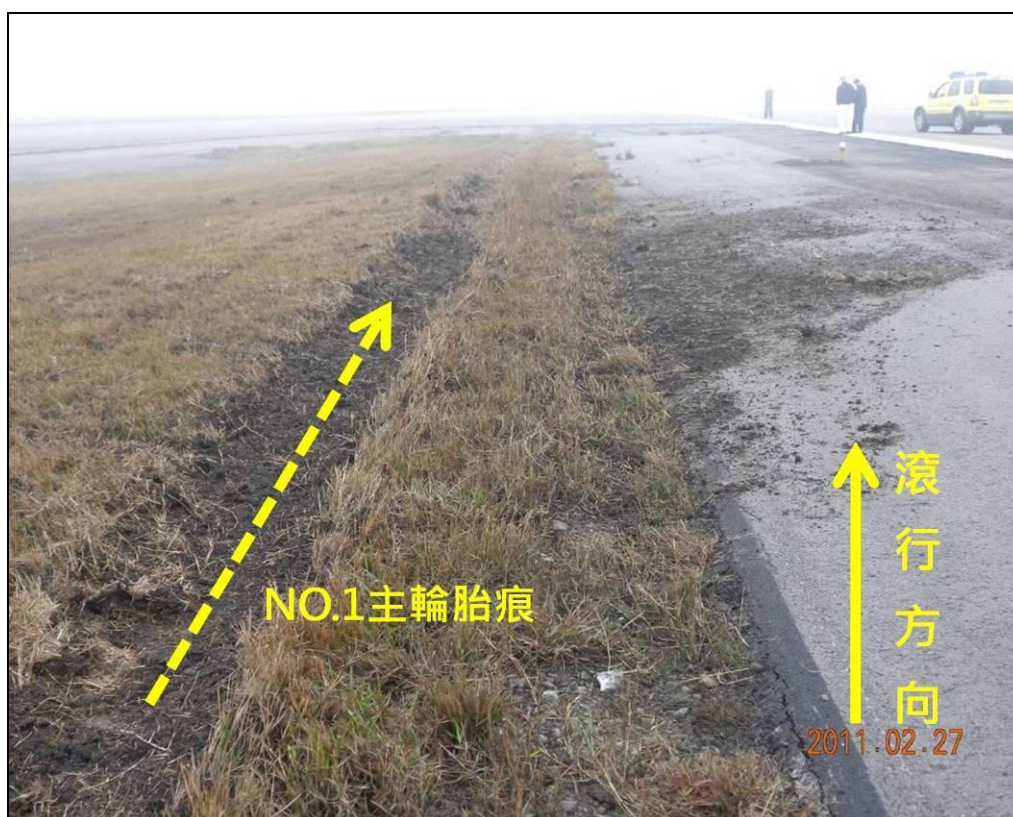
圖 2-2 BR757 班機落地滾行偏出跑道之輪胎痕跡
