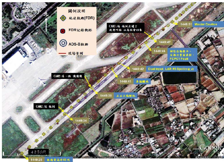
圖 4-2 某 A330 型機偏出跑道事故以飛航軌跡重建系統展示
