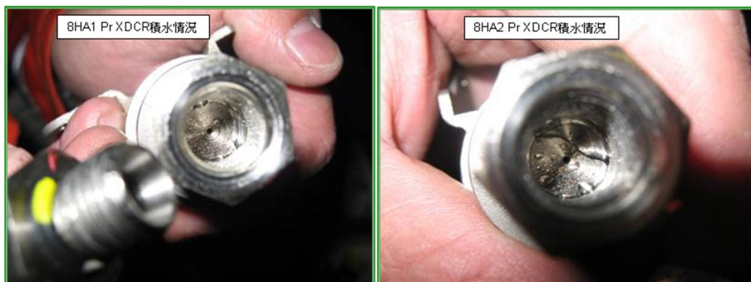
圖 2-1 Pr 感測器內部積水現象
