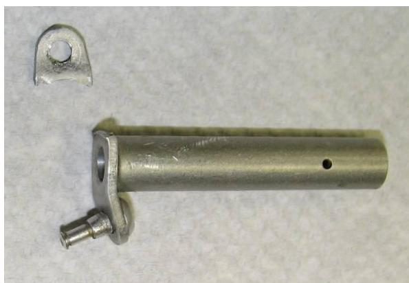
圖 2-7 斷裂電纜支架
