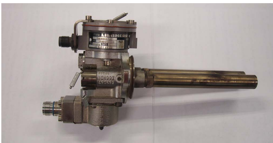
圖 2-12：CI781 事故機受損之控溫器
