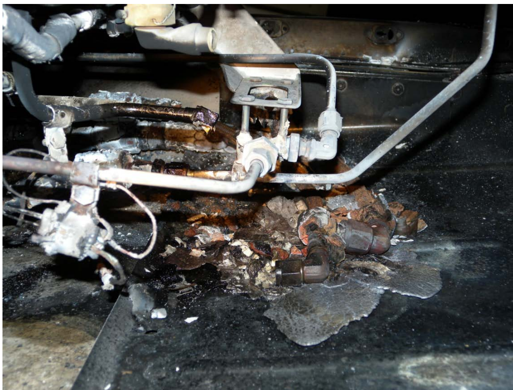
圖 2-5：GE 515 受損之發動機
