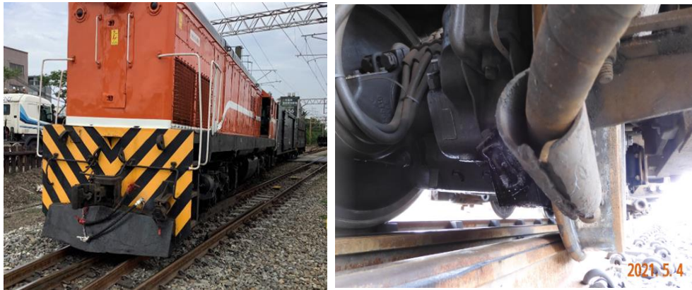
圖 2.1.3-5、圖 2.1.3-6 0504 臺鐵第 7142 次車成功站重大鐵道事故照片
