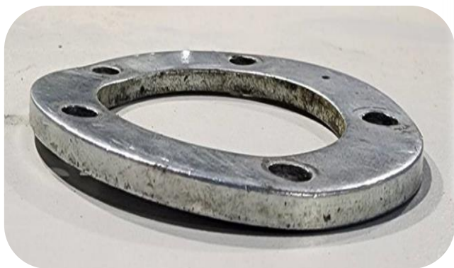
浮筒固定座螺絲孔有錯位情形 浮筒不鏽鋼固定座板片歪斜
